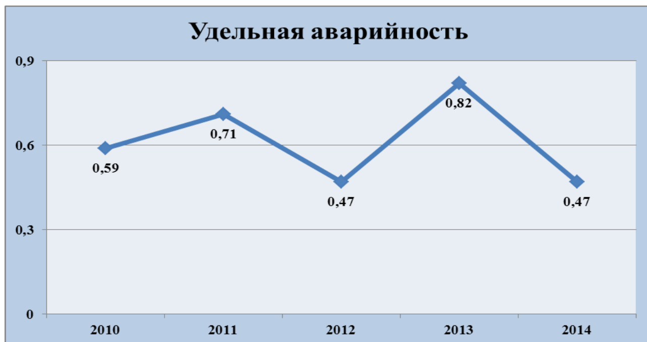
Рис. 75 Удельная аварийность на самотечных сетях водоотведения пгт. Балтаси
